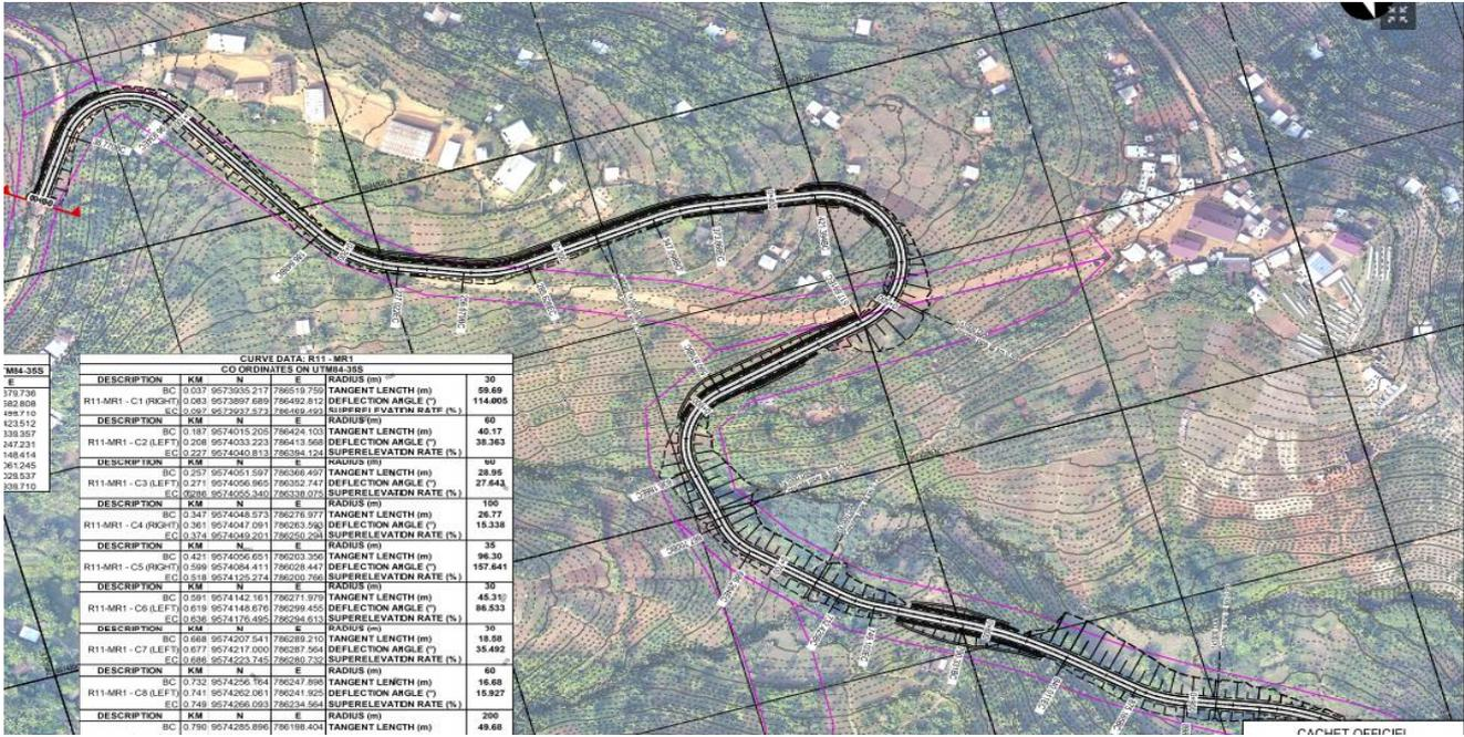
Figure 2: Dispositif d'emplacement de la route MR1 de 0.9 Km à 1.549 Km
